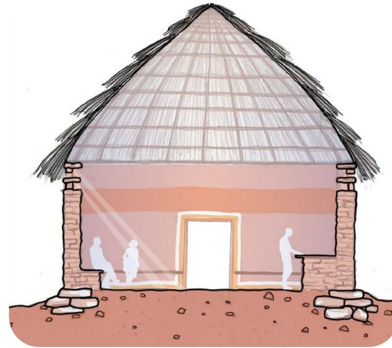
Les **cases traditionnelles Mbororos** sont réalisées en **terre crue avec un toit en chaume**. Les **cases des champs** sont réalisées en **structure bois et recouvertes de chaume**.
